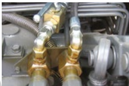
Hydraulisk tee som øker traktorens funksjonalitet ved å la kontakten være fri
