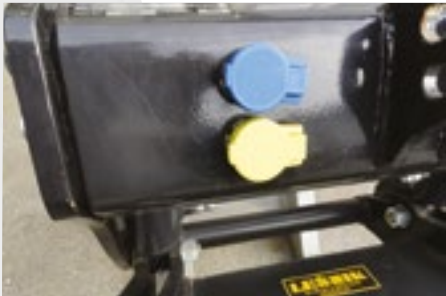
Ekstra ventilseter montert i øvre tverrstativ
