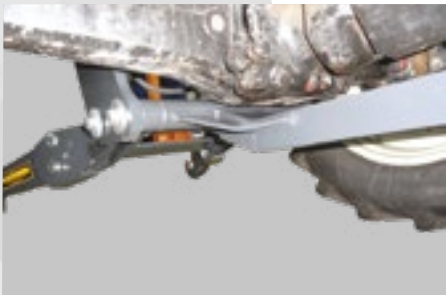
Bunnforsterkning montert på girkassen eller bakaksen
