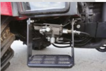
Ekstra hydraulisk kontroll fra traktoren - styrespak
