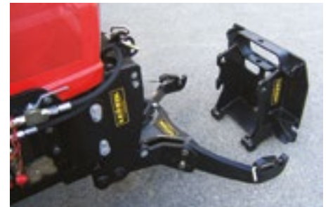
Plate for tilkobling av snøplogen (om vinteren)
